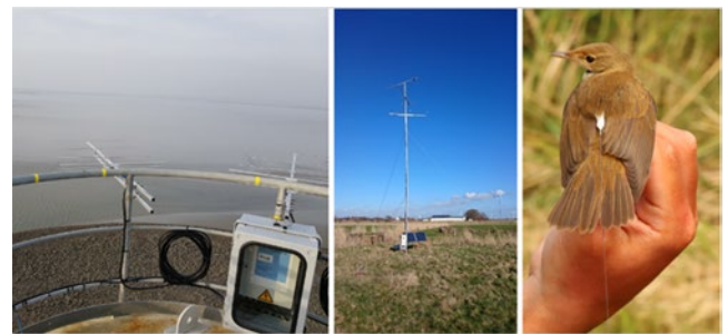
Abb. 3: MOTUS® Empfangsstationen/Antennen auf Helgoland und Teichrohrsänger mit Kleinstsender (Foto: T. Karwinkel)
