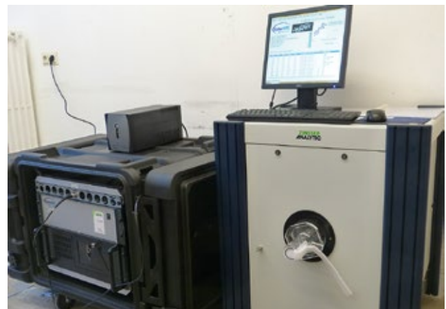
Abb. 2: EchoMRI™, bestehend aus dem Messgerät mit eingeschobener Messröhre (rechts) und einem Rechner (links). (Foto: F. Bairlein)
